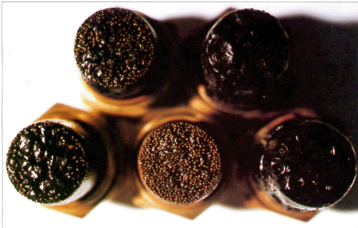
Ölbrennerdüsen nach 700stündigem Test. Links ohne Additiv HEL Guard, rechts mit Additiv HEL Guard. Der Unterschied ist frappant und macht jeden weiteren Kommentar überflüssig.
